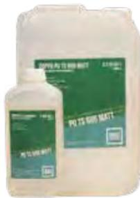
doppo PU TS686 ist eine spezielle, transparente, UV beständige, emissionsarme, wässrige 2K- Polyurethanversiegelung für den Schutz elastischer Bodenbeläge auf Polyurethan- und Epoxidharzbasis. doppo PU TS686 bildet einen extrem strapazierfähigen Film mit ausgezeichneter Elastizität, Haftung und hoher Chemikalienbeständigkeit, z.B. gegen farblose Desinfektionsmittel.
